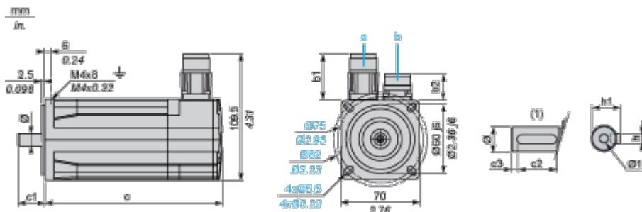
a: Alimentazione per freno servomotore
