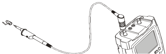
Figure 37. Connexion de la sonde de tension HF au moyen du ressort de masse
