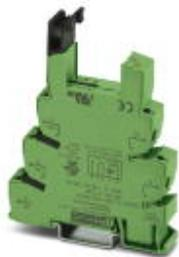
Morsetto base PLC da 14 mm senza equipaggiamento relè, per il montaggio su guide DIN NS 35/7,5, Connessione a vite, 1 di scambio, Tensione d'ingresso 120 V AC/DC
