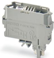
元件插头，专用于固定SKN 2.5二极管，标称工作电压: 400 V，额定电流: 1.25 A，接线方式: 直插式连接，深度: 37.5 mm，宽度: 12.3 mm，高度: 41.2 mm，位数: 1，颜色: 灰色，安装方式: 插拔式 (插槽)
