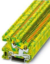
建筑安装用接地端子，标称工作电压: 800 V，额定电流: 24 A，直插式连接，第一层，额定接线容量: 2.5 mm<sup>2</sup>，横截面: 0.14 mm<sup>2</sup> - 4 mm<sup>2</sup>，安装方式: NS 35/7,5，NS 35/15，颜色: 黄绿相间
