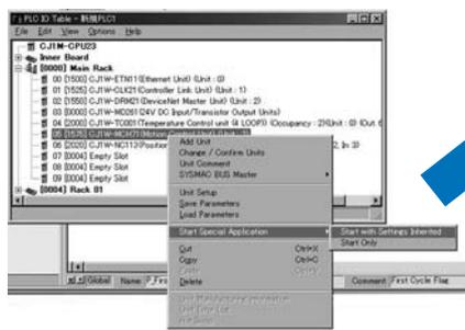
• Logiciel dédié au contrôle d'axes (CX-Motion).
