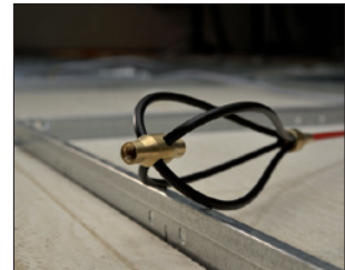
de geleidekop vereenvoudigt het geleiden van bekabeling of buizen over ruwe en oneffen oppervlakken.
