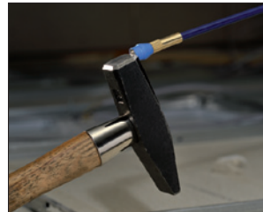
De sterke magneet kan metalen voorwerpen tot 2,5 kg tillen.
