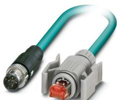
Câble de réseau, Ethernet CAT5 (100 Mbit/s), 4-pôles, blindé, connecteur mâle droit M12 SPEEDCONNEC / IP67, détrompage: D, sur connecteur mâle droit RJ45 Verrouillage à clip / IP67, longueur de câble: 2 m
