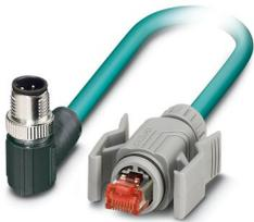
Câble de réseau, Ethernet CAT5 (100 Mbit/s), 4-pôles, Type de câble variable, blindé, connecteur mâle coudé M12 SPEEDCONNec / IP67, détrompage: D, sur connecteur mâle droit RJ45 Verrouillage à clip / IP67, longueur de câble: Longueur au choix (0,2... 40,0 m)
