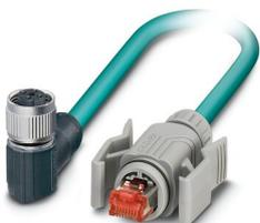
Câble de réseau, Ethernet CAT5 (100 Mbit/s), 4-pôles, Type de câble variable, blindé, connecteur mâle droit RJ45 Verrouillage à clip / IP67, sur connecteur femelle coudé M12 SPEEDCONNEC / IP67, détrompage: D, longueur de câble: Longueur au choix (0,2... 40,0 m)
