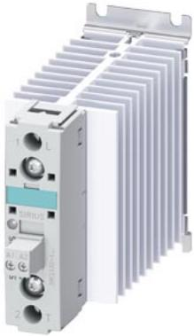
Halbleiterschütz 1-phasisig 3RF2 AC 51 / 30 A / 40 °C 48-600 V / DC 4-30 V
