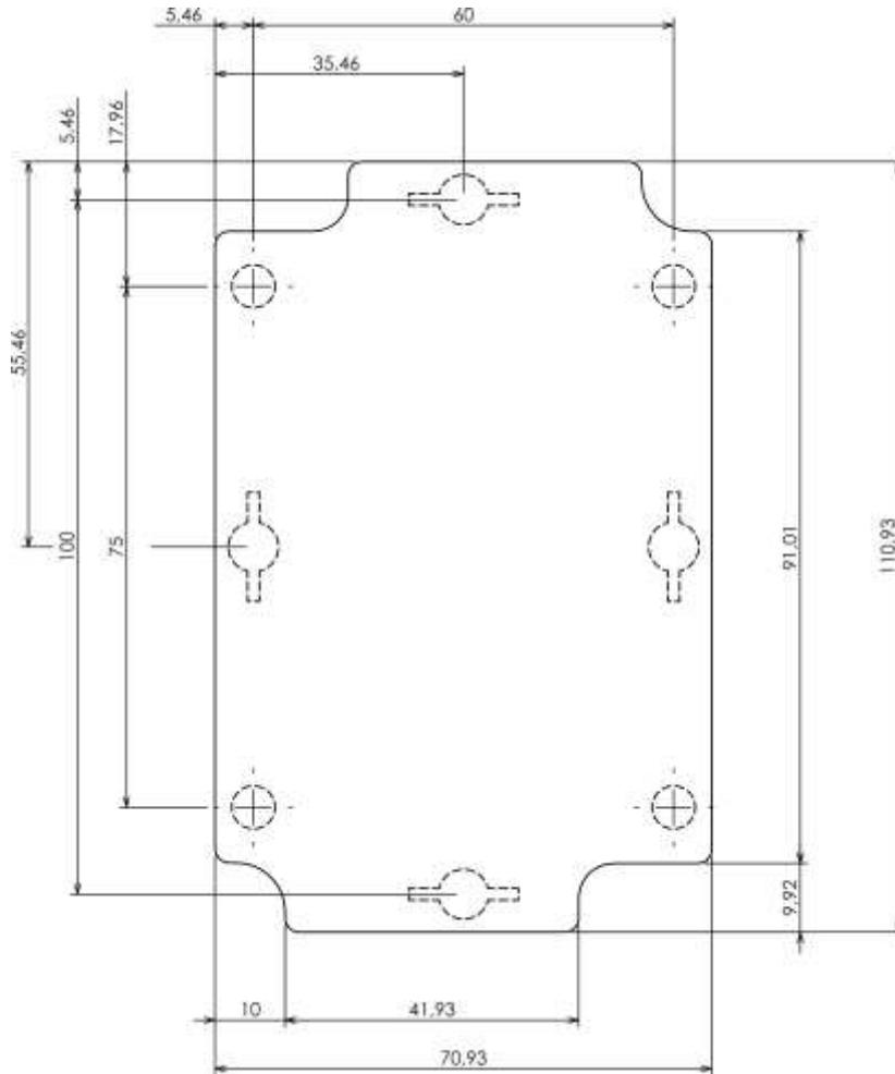
Die gestrichelte Linie zeigt die Umriss des Stecksockels unter der Leiterplatte
