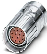
M23，电缆连接器，系列: CA，直头，屏蔽: 有，螺钉锁紧，位数: 12，旋转方向: 逆向，触点类型: 孔式插头，压接，电缆直径范围: 3 mm ... 14.5 mm，编码: N，根据RoHS II指令（不含豁免条款6c，即铅含量<0.1%），本产品预计自2026年第二季度起实现无铅化；如需提前获得无铅替代品，可应要求提供
