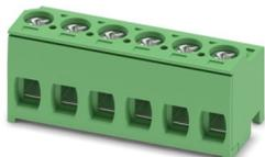
PCB插拔式连接器，额定横截面: 1.5 mm<sup>2</sup>，颜色: 绿色，额定电流: 10 A，额定电压(III/2): 400 V，触点表面: Sn，触点类型: 孔式插头，电位数: 6，行数: 1，位数: 6，连接量: 6，产品系列: PT 1,5/...-PH，针距: 5 mm，接线方式: 带压片的螺钉连接，螺钉头规格: H1L 十字沉头螺丝，适用Torx一字型螺丝刀，导线/PCB连接方向: 0°，插拔系统: COMBICON PST 1,3，互锁: 不带，安装方式: 不带，包装类型: 纸箱包装
