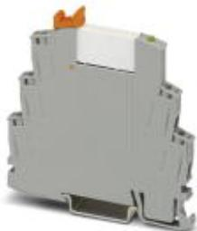
Modulo portarelè montato con connessione a vite, composto da: base relè con espulsore e relè a contatto di potenza. Esecuzione contatti: 1 contatto di scambio. Tensione di ingresso 24 V DC
