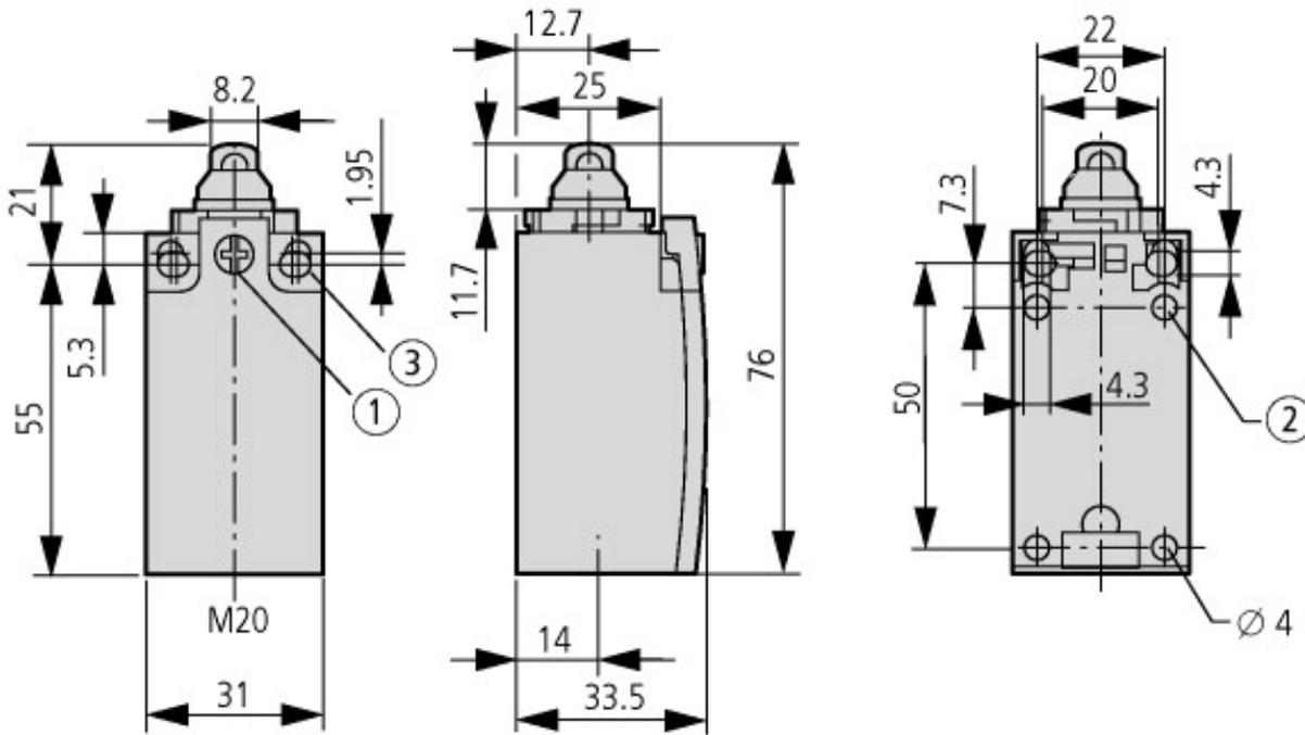
① Anzugsdrehmoment Deckelschraube: 0.8 Nm  $\pm$ 0.2 Nm
