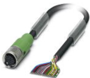
センサ/アクチュエータケーブル, 17-極, PVC, 黒RAL 9005, 片側フリー, 上 ソケット ストレート M12 SPEEDCON, Aコーディング, ケーブル長: 5 m
