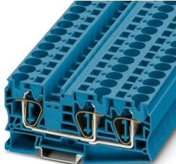
直通式接线端子，标称工作电压: 1000 V，额定电流: 76 A，连接量: 3，接线方式: 回拉式弹簧连接，额定接线容量: 16 mm<sup>2</sup>，横截面: 0.2 mm<sup>2</sup> - 25 mm<sup>2</sup>，安装方式: NS 35/15，NS 35/7.5，颜色: 蓝色
