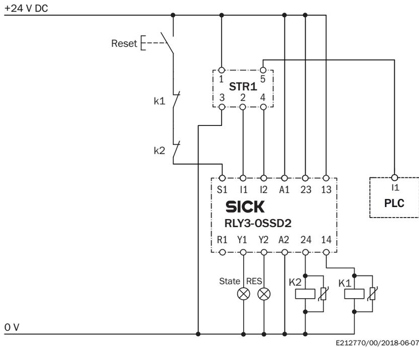
Deux interrupteurs de sécurité à transpondeur STR1 connectés en parallèle à un système de commande de sécurité Flexi Classic
