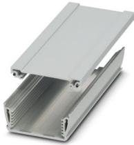
型材外壳，壁式安装（可选配附件），铝制型材，2件，型材宽度（内部）：53.5 mm，型材宽度（外部）：74 mm，长度：100 mm，高度：74 mm，深度：32.8 mm
