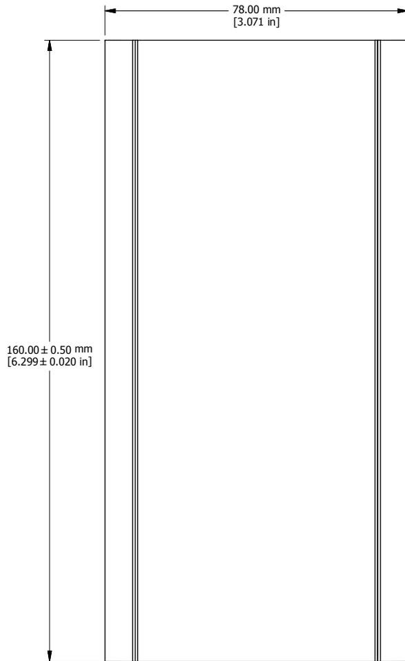
EXTRUSION DESIGNED FOR 75MM WIDE PC BOARD
