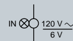
Voyant à transformateur primaire 110/120 V secondaire 6 V Lampe BA 9s à incandescence
