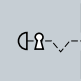
"Coup de poing" Arrêt d'urgence - Tourner pour déverrouiller à clé Contact "O"
