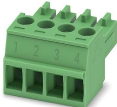
プリント基板用コネクタ、定格接続サイズ: 1.5 mm<sup>2</sup>、色: 緑、定格電流: 8 A、定格電圧 ( III/2 ): 160 V、コンタクト表面: Sn、コンタクトタイプ: メス、電位の数: 4、列の数: 1、極数: 4、接続数: 4、製品ラインアップ: MC 1,5/-ST、ピッチ: 3.5 mm、接続方式: クランプケージ仕様のねじ接続方式、ねじ頭型: L マイナス、電線/プリント基板の接続方向: 0 °、プラグインシステム: COMBICON MC 1,5、嵌合ロック: なし、取付け方法: なし、梱包の種類: 段ボール梱包
