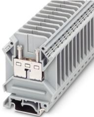
直通式接线端子，标称工作电压: 2000 V，额定电流: 41 A，连接量: 2，接线方式: 螺钉连接，横截面: 0.5 mm<sup>2</sup> - 10 mm<sup>2</sup>，安装方式: NS 35/7,5，NS 35/15，NS 32，颜色: 灰色
