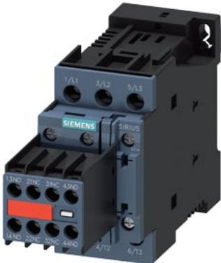
Leistungsschütz, AC-3e/AC-3, 17 A, 7,5 kW / 400 V, 3-polig, DC 24 V, Hilfskontakte: 2 S + 2 Ö, Schraubanschluss, Baugröße: S0, Hilfsschalter unlösbar, kein Überspannungsbegrenzer nachrüstbar
