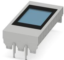
DIN导轨壳体，10U上部部件，内置2.4"电阻式触摸屏，分辨率: 320 x 240 像素，接口: 4线制SPI半双工，外壳盖板，宽度: 56.88 mm，高度: 109.8 mm，深度: 29.5 mm
