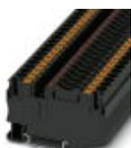
Borne de carril para fusible, tipo de fusible: Plano, tipo de conexión: Conexión push-in, sección: 0,5 mm<sup>2</sup>- 10 mm<sup>2</sup>, AWG: 20 - 8, corriente nominal: 25 A, tensión nominal: 12 V, anchura: 8,2 mm, tipo de fusible: C, clase de montaje: NS 35/7,5, NS 35/15, color: negro
