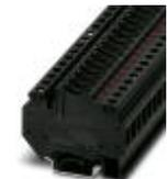
Borne para fusible plano, sección: 0,2-6 mm<sup>2</sup>, AWG: 26-8, anchura: 8,2 mm, color: Negro, con indicación luminosa, tensión indicación luminosa: 24 V DC, corriente indicación luminosa: 2 mA
