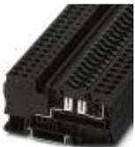
Borne de carril para fusible, tipo de fusible: Plano, tipo de conexión: Conexión por resorte, sección: 0,08 mm<sup>2</sup>- 6 mm<sup>2</sup>, AWG: 28 - 10, corriente nominal: 30 A, tensión nominal: 400 V, anchura: 8,2 mm, tipo de fusible: C, clase de montaje: NS 35/7,5, NS 35/15, color: negro
