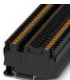
Borne de carril para fusible, tipo de fusible: Plano, tipo de conexión: Conexión push-in, sección: 0,5 mm<sup>2</sup>- 10 mm<sup>2</sup>, AWG: 20 - 8, corriente nominal: 25 A, tensión nominal: 24 V, anchura: 8,2 mm, tipo de fusible: C, clase de montaje: NS 35/7,5, NS 35/15, color: negro
