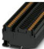
Borne de carril para fusible, tipo de fusible: Plano, tipo de conexión: Conexión push-in, sección: 0,5 mm<sup>2</sup>- 10 mm<sup>2</sup>, AWG: 20 - 8, corriente nominal: 25 A, tensión nominal: 400 V, anchura: 8,2 mm, tipo de fusible: C, clase de montaje: NS 35/7,5, NS 35/15, color: negro
