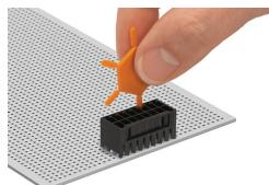
Codage d'un connecteur femelle en faisant glisser un détrompage.
