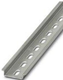
Guida di supporto forata, Profilo standard, larghezza: 35 mm, altezza: 7,5 mm, a norma EN 60715, materiale: Acciaio, non rivestito, lunghezza: 2000 mm, colore: alluminio/bianco
