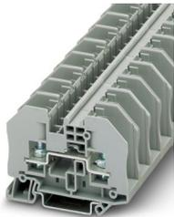
螺栓接线端子，标称工作电压: 1000 V，额定电流: 41 A，连接量: 2，接线方式: 螺栓连接，第一层，额定接线容量: 6 mm<sup>2</sup>，安装方式: NS 35/7,5，NS 35/15，颜色: 灰色
