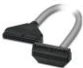
Cavo intestato; collegamento 1: IDC/FLK conduttore femmina (1x 40-poli, 180 °-Uscita); collegamento 2: IDC/FLK conduttore femmina (1x 40-poli, 90 °-uscita); lunghezza cavo: variabile
