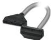
Cavo intestato; collegamento 1: IDC/FLK conduttore femmina (1x 40-poli, 180 °-Uscita); collegamento 2: IDC/FLK conduttore femmina (1x 40-poli, 90 °-uscita); lunghezza cavo: 0,5 m
