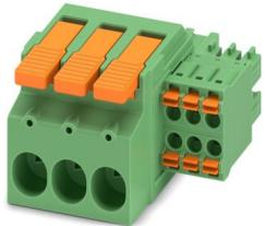
PCB混合连接器，额定横截面: 6 mm<sup>2</sup>，颜色: 绿色，额定电流: 41 A，8 A，额定电压(III/2): 1000 V，触点表面: Sn，触点类型: 孔式插头，电位数: 9，行数: 1，位数: 9，连接量: 9，产品系列: LPCH 6/..+6-ST，针距: 7.62 mm，接线方式: 直插式连接，导线/PCB连接方向: 0°，插拔系统: COMBICON PC 6 hybrid，互锁: 不带，安装方式: 不带，包装类型: 纸箱包装
