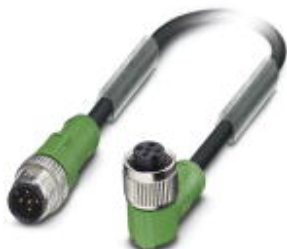
センサ/アクチュエータケーブル, 5-極, PUR ハロゲンフリー, 黒-灰RAL 7021, プラグ ストレート M12, Aコーデイング, 上 ソケット アングル M12, Aコーデイング, ケーブル長: 3 m
