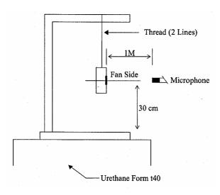
1 METER FROM MICROPHONE TO FAN INTAKE
