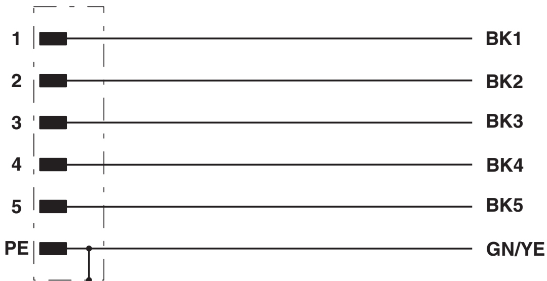
Kontaktbelegung des M12-Steckers
