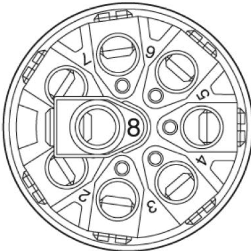
Kabelanschlussseite M12 (Schraubanschluss)
