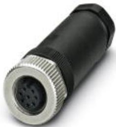
Steckverbinder, Universal, 8-polig, Buchse gerade M12, A-kodiert, Schraubanschluss, Rändelmaterial: Zinkdruckguss, vernickelt, Kabelverschraubung Pg9, Kabelaußendurchmesser 6 mm ... 8 mm
