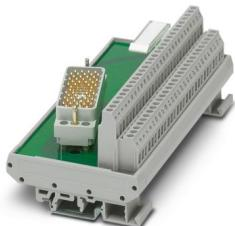
Übergabemodul, Anschluss 1: Schraubanschluss, Anschluss 2: EDAC / ELCO-Stifteleiste 1x 56-polig (ELCO Stifteleiste Typ 8016 / EDAC Stifteleiste Typ 516, rechts)
