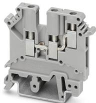
直通式接线端子，标称工作电压: 400 V，额定电流: 24 A，接线方式: 螺钉连接，第一层，额定接线容量: 2.5 mm<sup>2</sup>，横截面: 0.2 mm<sup>2</sup> - 2.5 mm<sup>2</sup>，安装方式: NS 35/7,5，NS 35/15，NS 32，颜色: 灰色
