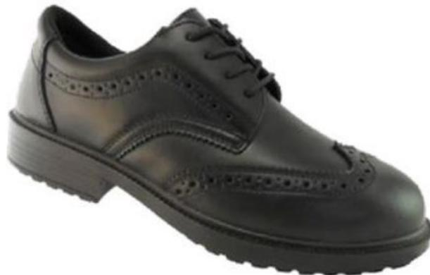
**Descripción:** parte superior de cuero flexible, construcción antiestática, conformidad ESD , suela exterior de doble densidad PU/PU, antideslizante SRC , puntera de acero y media suela de acero
