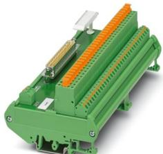
16-kanaliges Modul für Honeywell C300 Baugruppen. Das Modul wird steuerungsseitig über D-SUB 37-polig angesteuert. Feldseitig steht ein Federkraftanschluss (1+, 1-,...16+,16-) mit Messertrennung zur Verfügung. Modulbreite: 254 mm
