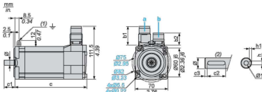
a: Alimentazione per freno servomotore
