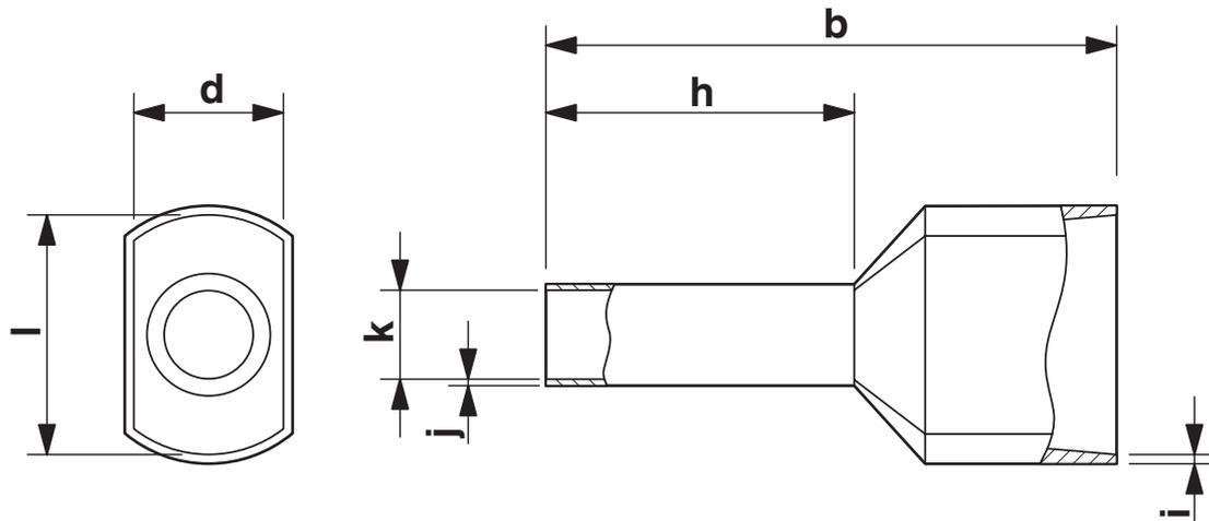
套管长度 (b)、接触范围长度 (h)、绝缘套管内部尺寸 (d)、套管直径 (k)、绝缘套管厚度 (i)、套管壁厚 (j)
