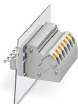
嵌板穿通接线柱块，接线方式: 直插式弹簧连接，焊接，位数: 1，负载电流: 32 A，横截面:  $0.2 \text{ mm}^2 - 4 \text{ mm}^2$ ，导线连接方向与拔插方向的夹角:  $45^\circ$ ，宽度: 8.1 mm，颜色: 灰色
