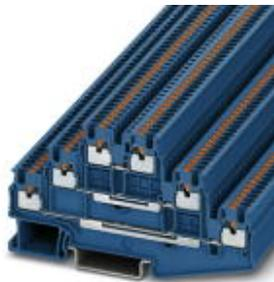
Bloc de jonction à plusieurs étages, type de raccordement: Raccordement Push-in, section : 0,14 mm<sup>2</sup> - 1,5 mm<sup>2</sup>, AWG: 26 - 14, largeur: 3,5 mm, coloris: bleu, type de montage: NS 35/7,5, NS 35/15
