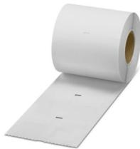
Wire-Wrap标签，盘卷，白色，未标记，适用的打印机：THERMOMARK E.300 (D)/600 (D)，THERMOMARK ROLL 2.0，THERMOMARK ROLL，THERMOMARK ROLL X1，THERMOMARK ROLLMASTER 300/600，THERMOMARK X1.2，电缆直径范围：6.1 ... 14.2 mm，安装方式：背胶固定，电缆直径： $\leq$  14.2 mm，标签数：3000，文本框高度：19.1 mm，文本框宽度：38.1 mm
