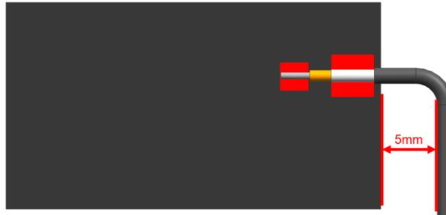
FIGURE 5.2.1 CABLE BENDING
