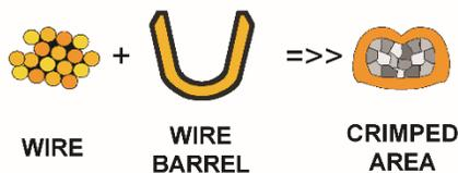
$$\text{TOTAL UNCRIMPED AREA} = \text{WIRE} + \text{BARREL}$$
