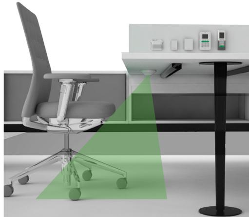
L'angle du capteur influe sur la position de la zone de détection. Si l'angle est modifié, alors la zone de détection est décalée.
