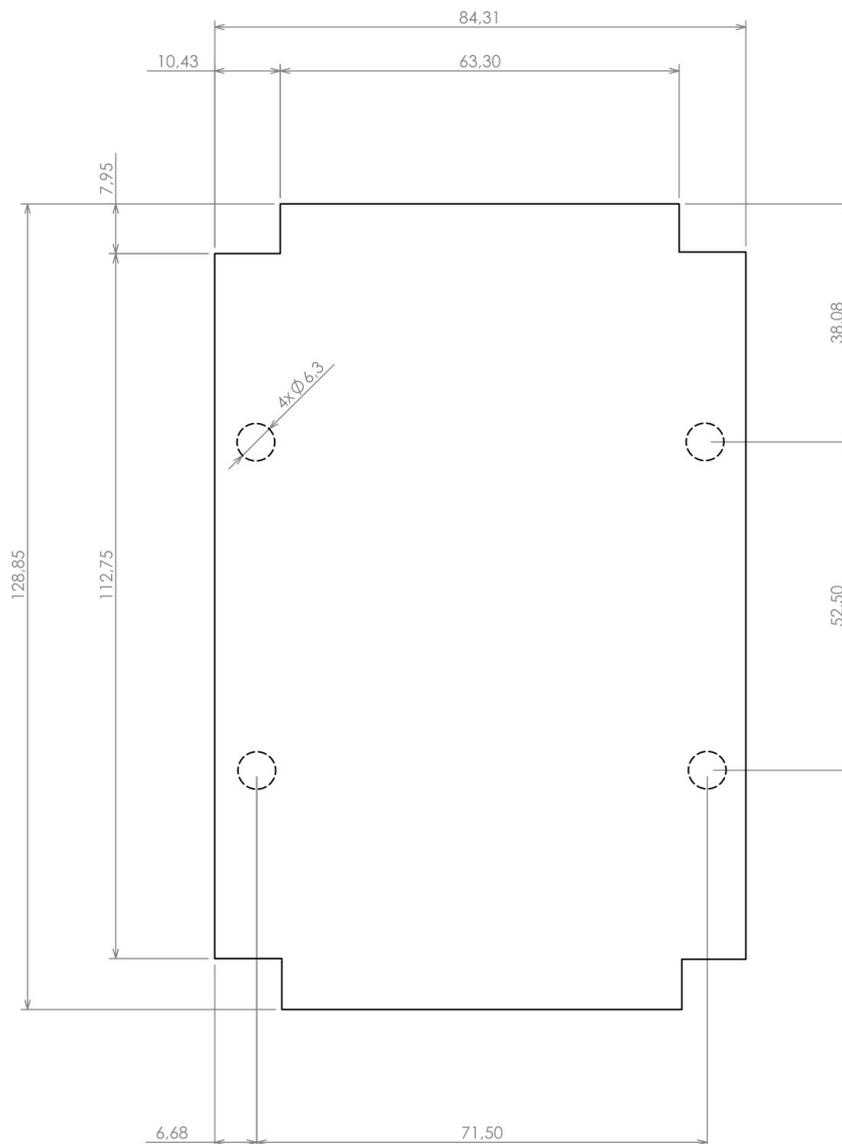
La ligne en pointillés indique le contour du bossage de montage sous la carte de circuit imprimé
