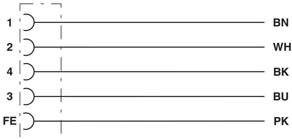
Kontaktbelegung der M12-Buchse
