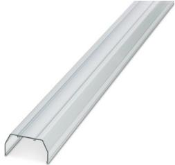
绝缘保护盖罩，用于端子条的遮盖保护，快速连接绝缘保护盖罩支架AP 3-TU，AP 3-TNS 35，可使用插入式标记条AP-ES标记。绝缘保护盖罩支架应安装在端子末端，间距大约40 cm 长度：1 m
