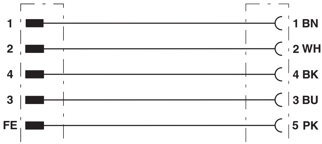
Kontaktbelegung der M12-Stecker/Buchse
